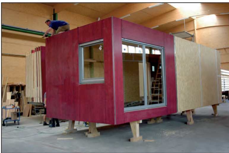
100 % Fertigung in der Halle – auch größere Gebäudekomplexe aus Einzelmodulen werden in der Halle komplett bezugsfertig gefertigt
